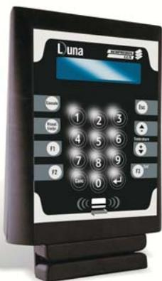
Luna è un terminale di raccolta dati di nuova generazione e di facile programmabilità, la qualità dei componenti unita all'uso della tecnologia SMD ha permesso di ottenere un'elevata compattezza e affidabilità dei dispositivi elettronici interni di controllo.
